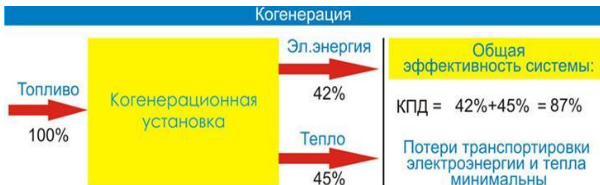
Рисунок 19 – Схема процесса когенерации
