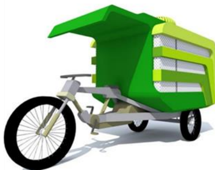
Рисунок 14 -Электрический трехколесный велосипед с холодильным отделением компании Fruiti-Cycle
