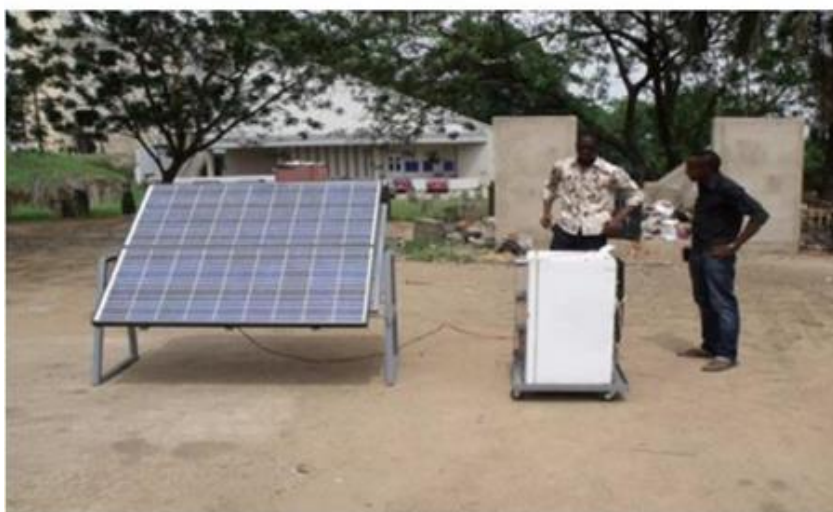
Рисунок 13- Холодильник, работающий на солнечной тепловой энергии
