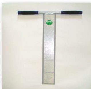
Рис. 1 – Инструмент для закладки в почву образцов ткани и фотобумаги
