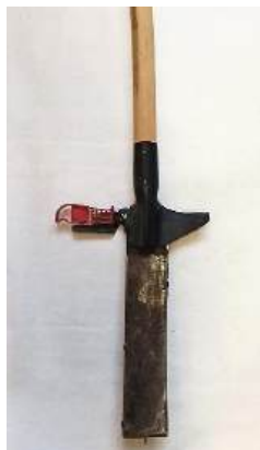
Рис. 3. – Устройство для создания щели в почве и закладки в нее образцов ткани или фотобумаги при изучении биологической активности почвы
