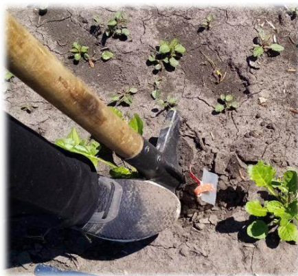
Рис. 2 – Инструмент для создания щели при закладке в почву образцов ткани и фотобумаги для изучения биологической активности почвы
