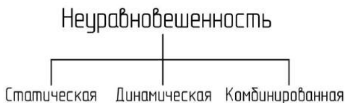
Рисунок 1 – Виды неуравновешенности двигателей автомобилей
